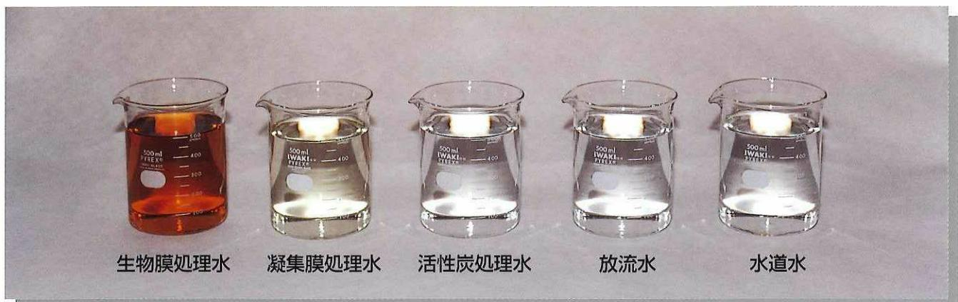
生物膜処理水 凝集膜処理水 活性炭処理水 放流水 水道水
